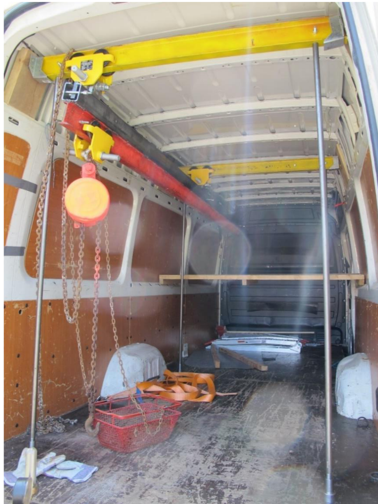
Obr. 46 Zdvihací zařízení v dodávkovém automobilu.
