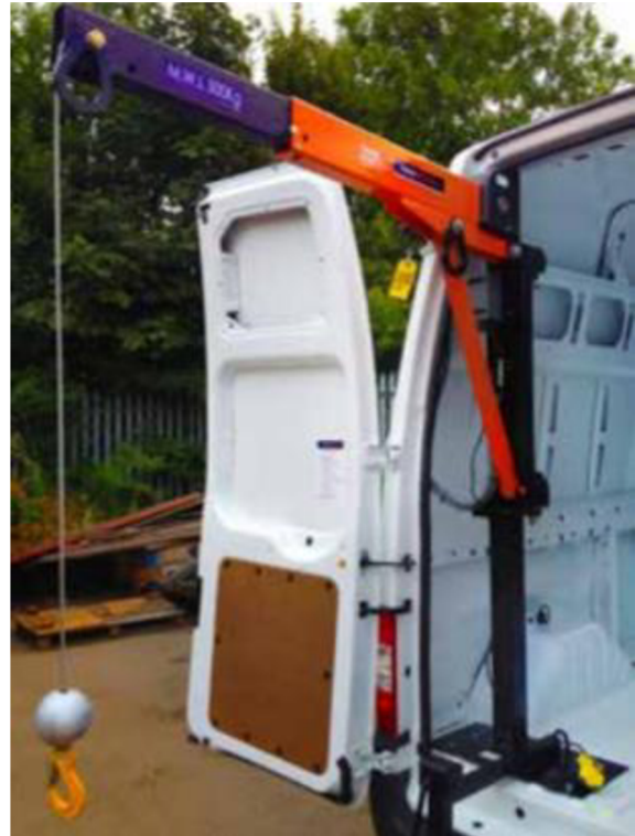
Obr. 20 Swing Lift ML500 sloupový jeřáb. [13, 14]
