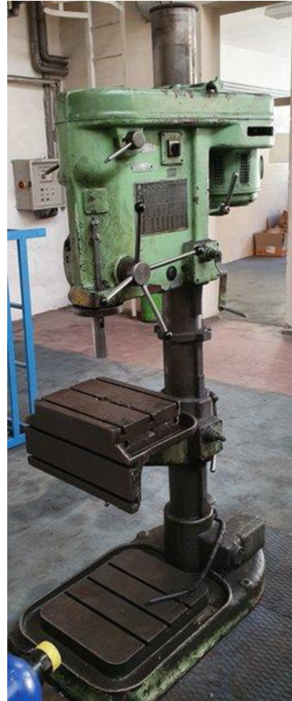
Obr. 34 Sloupová vrtačka TOS VS32A. [32, 33]
