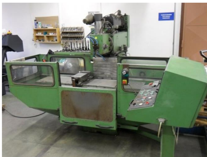
Obr. 32 Konzolová frézka FGSQ 32 CNC B. [36]
