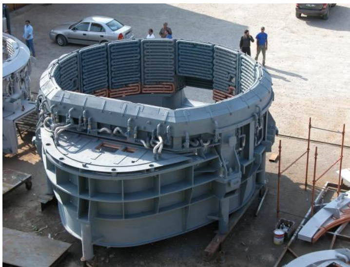
Obr. 6) Chlazení pomocí vysokotlakých trubek uspořádaných do panelů [15]
