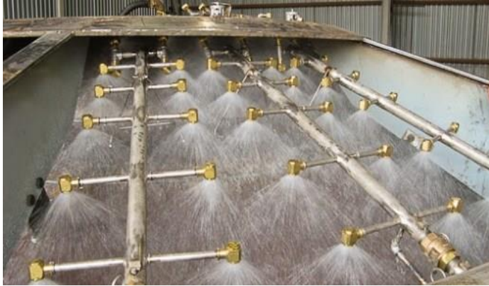
Obr. 7) Systém chlazení pomocí trysek [16]
