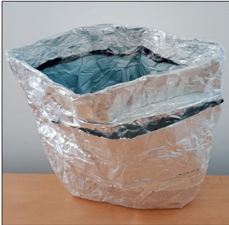
Obr. 3.4 Alobalové odstínění umístěné v kabelce
