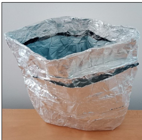
Obr. 3.4 Alobalové odstínění umístěné v kabelce
