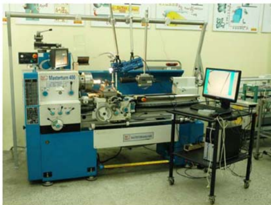
Obr 1.20 Pracoviště pro výzkum tvorby třísky v oblasti soustružení [49].
