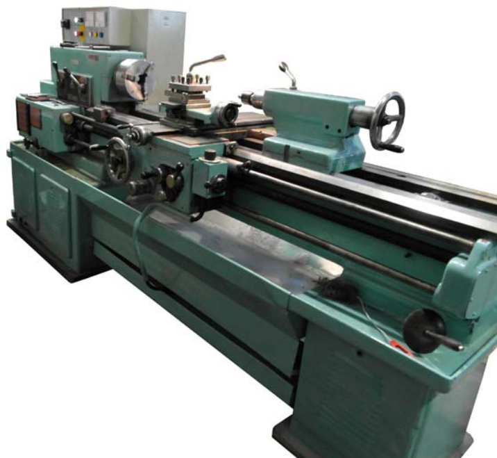
Obr. 4.1 Soustruh 18RD použitý při experimentu.
