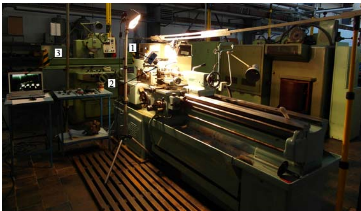
1 - vysokorychlostní kamera, 2 - držák kamery, 3 - PC vybavený softwarem CamLink a MotionMeasure
