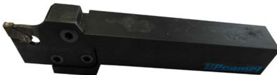
Obr. 4.9 Nůž a planžeta potřebná pro upnutí VBD použitých v experimentech.
