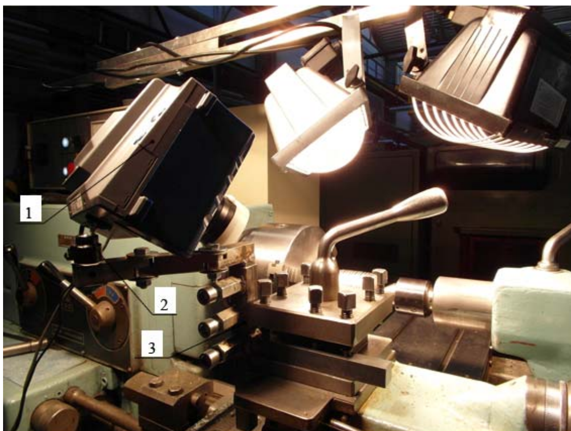
1 - vysokorychlostní kamera TroubleShooter 1000, 2 - nastavitelná stativová hlava, 3 - držák kamery
