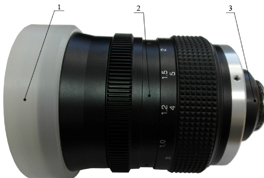
1 - ochranný silikonový kroužek, 2 - objektiv s označením OA, 3 - distanční mezikroužek
