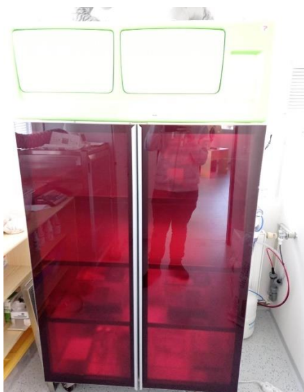
Obr. 11 Speciální skříň, do které se ukládají boxy a klece s živými modelovými zvířaty. Dají se zde nastavit parametry vnitřního prostředí, jako je např. teplota nebo vlhkost vzduchu. Zdroj: Autor
