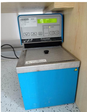
Obr. 12 Ohřivač vody pro vyhřívání modelových zvířat. Zdroj: Autor
