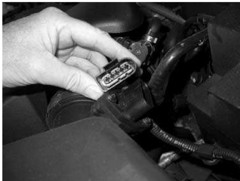
Obr. 35 Test akčních členů - měřič hmotnosti vzduchu [8]
