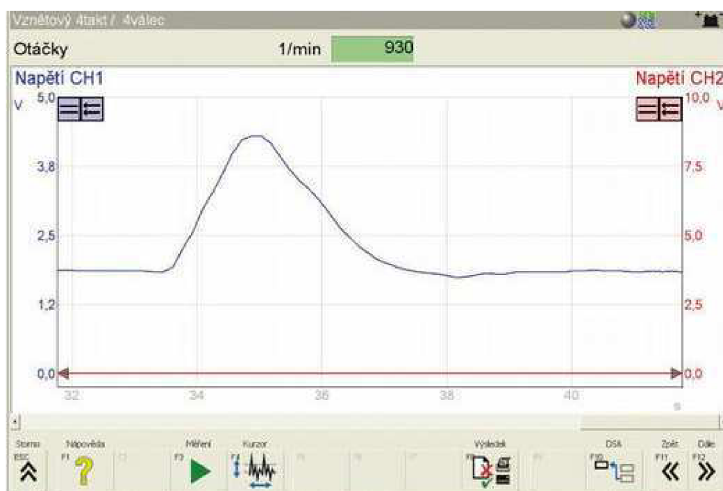
Obr. 38 Bosch FSA - Oscilogram kontroly měřiče hmotnosti vzduchu [15]
