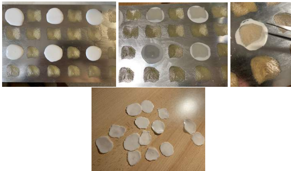
Obrázek 5.6: Průběh výroby falzifikátu pomocí lepidla herkules z DPS.
