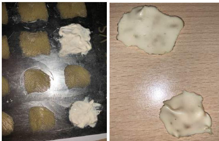
Obrázek 5.7: Průběh výroby falzifikátu pomocí tekutého latexu z DPS.
