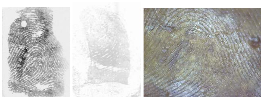
Obrázek 5.14: Falzifikát z tekutého latexu, zleva doprava: snímač ZKTeco, Eikon Touch, mikroskop.
