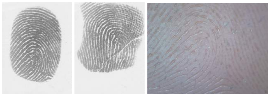
Obrázek 5.12: Falzifikáty z plastelíny, nasnímané senzorem ZKTeco (první dva) a mikroskopem (vpravo).
