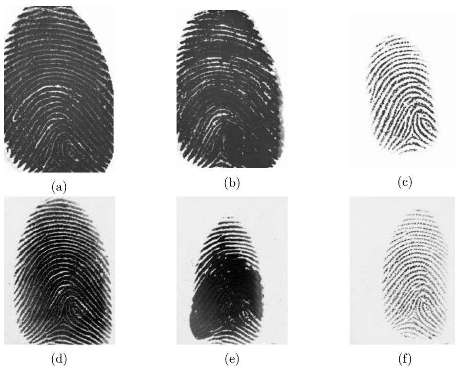
Obrázek 5.9: Nekvalitní snímky ze snímačů ZKTeco (a, b, c) a Eikon Touch (d, e, f).
