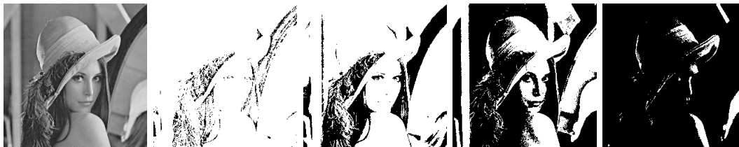
Obrázek 4.2: Ukázka prahování s různě stanoveným prahem, zleva doprava: původní šedotónový snímek, prahování s prahem 45, 80, 140 a 200.
