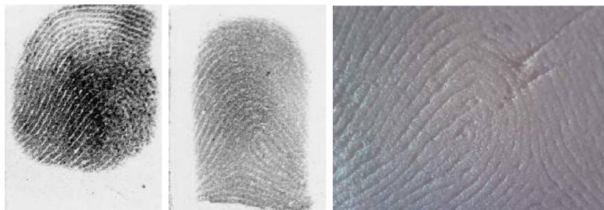
Obrázek 5.15: Falzifikáty z materiálu Funny gummy, nasnímané senzorem ZKTeco a mikroskopem (v tomto pořadí).
