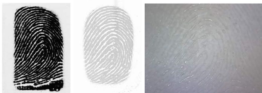
Obrázek 5.11: Falzifikáty z Herkulesu nasnímané zleva pomocí senzorů: ZKTeco, Eikon Touch, mikroskop.
