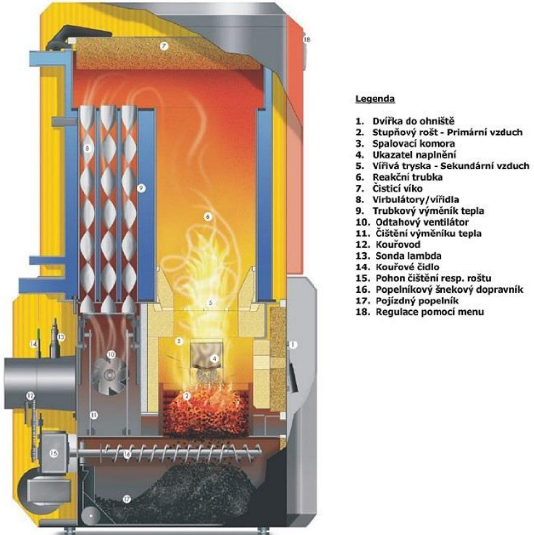
Obr. 5.8 Automatický kotel na dřevní štěpku (9)
