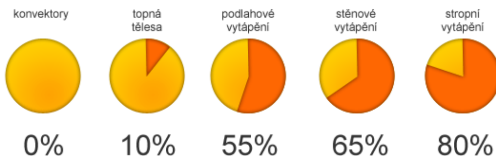
Obr. 8.4 Podíl tepelného toku sáláním pro různé druhy vytápění (24)
