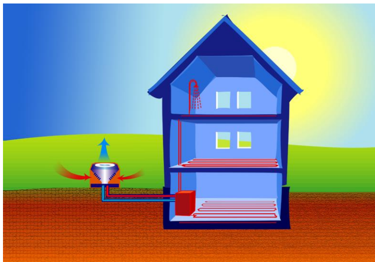
Obr. 9.2 Způsob provedení tepelného čerpadla Vzduch/Voda (26)
