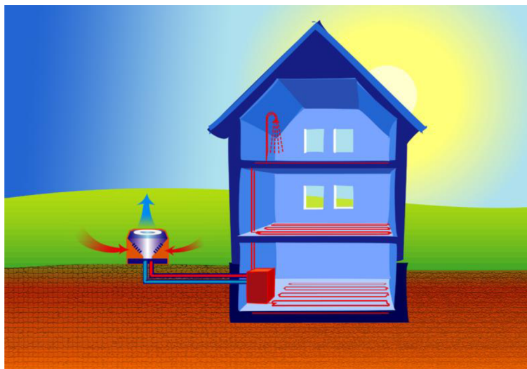
Obr. 9.2 Způsob provedení tepelného čerpadla Vzduch/Voda (26)
