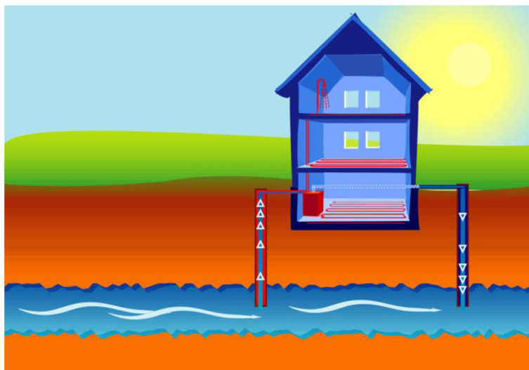
Obr. 9.3 Způsob provedení tepelného čerpadla Voda/Voda (27)
