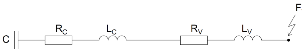
Obrázek 20 Náhradní schéma zapojení kondenzátoru a vedení
