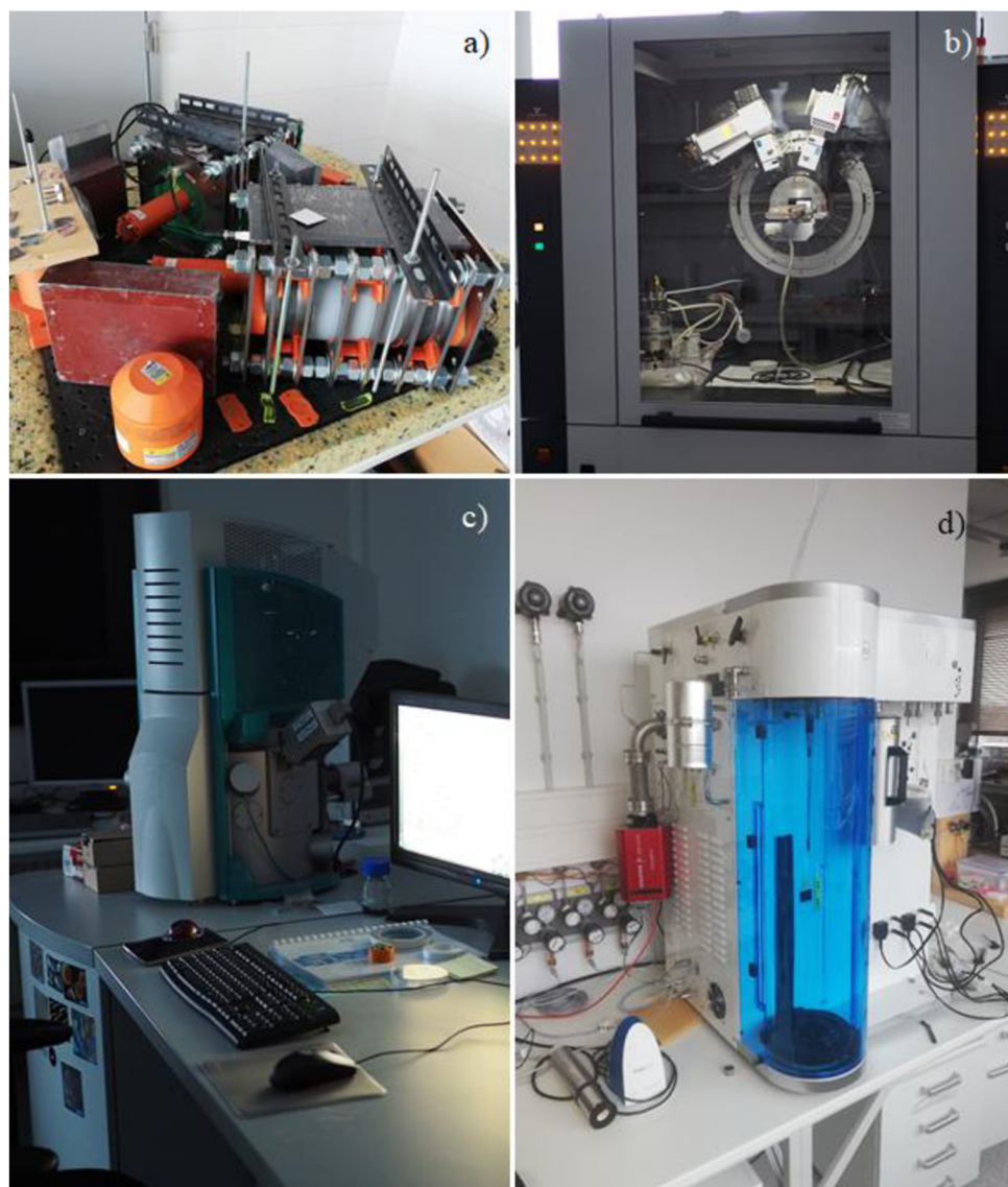
Obr. 8: a) Duální Mössbauerův spektrometr OLTWINS, b) Rentgenový difraktometr Bruker D8 ADVANCE, c) Skenovací elektronový mikroskop Tescan VEGA3 LMU a d) Adsorpční analyzátor Autosorb iQ.
