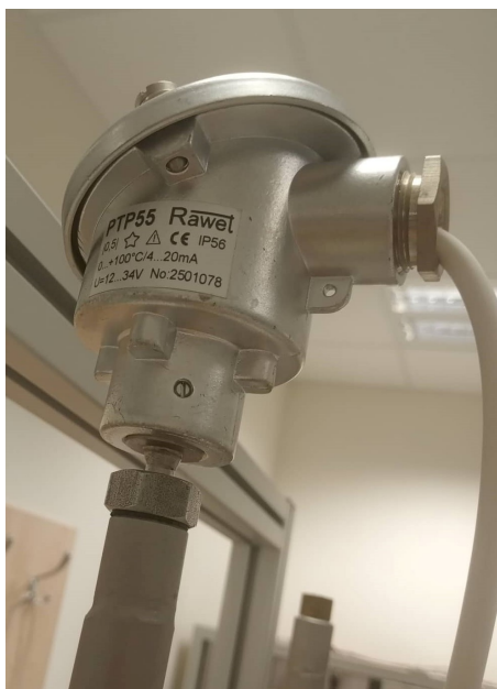
Obr. 1.7: Stonkový teplotní snímač PTP55 od firmy Rawet[9]
