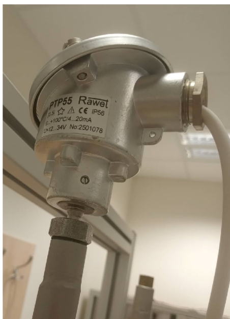
Obr. 1.7: Stonkový teplotní snímač PTP55 od firmy Rawet[9]
