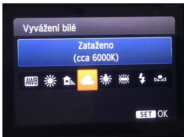
Obr.20 Režim hodnot vyvážení bílé
