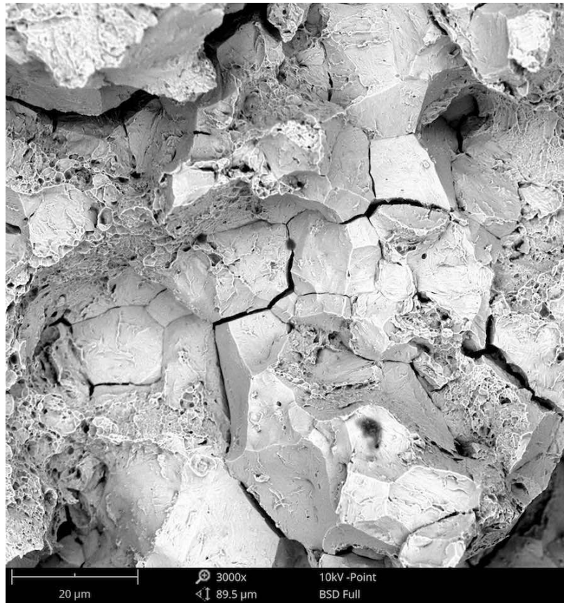
Obrázek 7: Interkrystalický křehký lom, pořízeno SEM, 3000x zvětšení (22)
