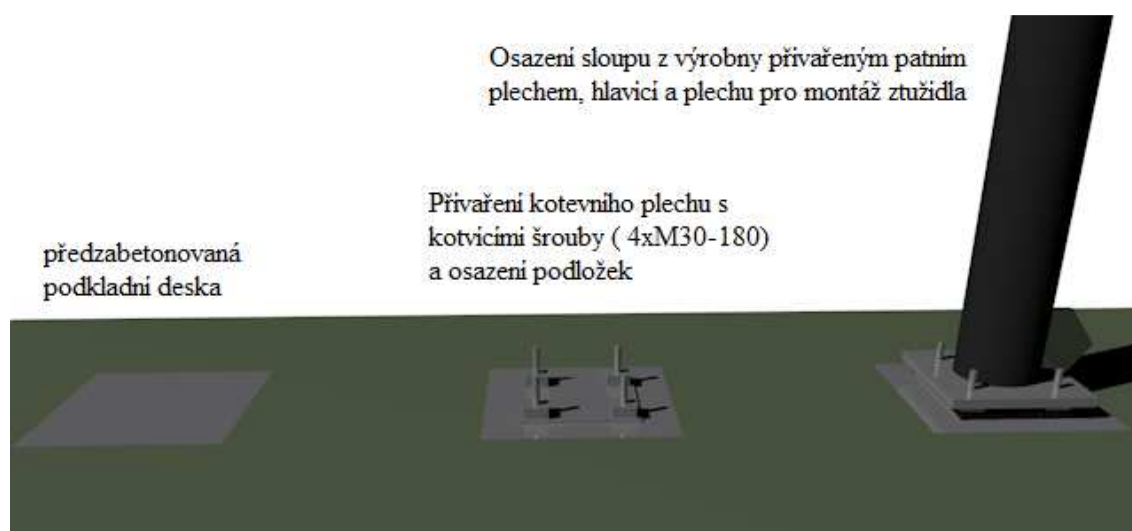
Obr. 5.1 Axonometrické schéma kotvení sloupu
