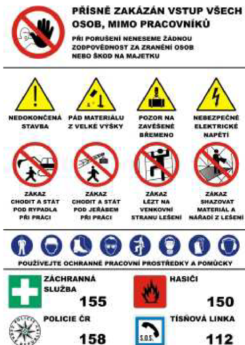
Obr. 9.1 Výstražný baner u vstupu na staveniště
