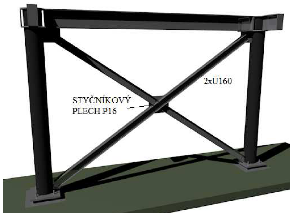
Obr. 5.2 Axonometrický pohled na ztužidla
