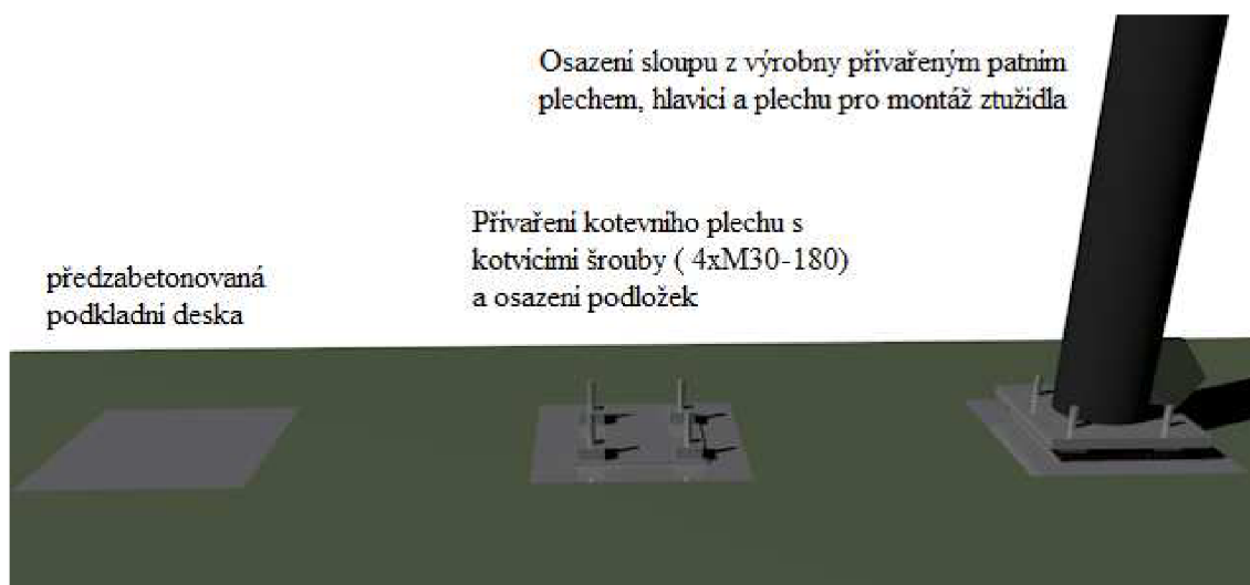
Obr. 5.1 Axonometrické schéma kotvení sloupu
