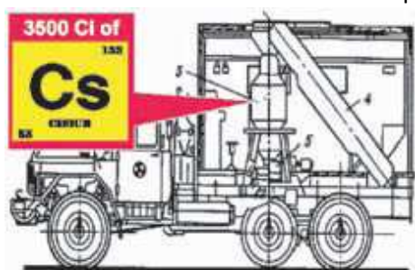
Obrázek 10 – Uložení ozařovače v dopravním prostředku.
