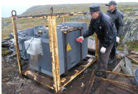
Obrázky 15, 16 – Radioizotopový termoelektrický generátor, zářič Sr-90.
