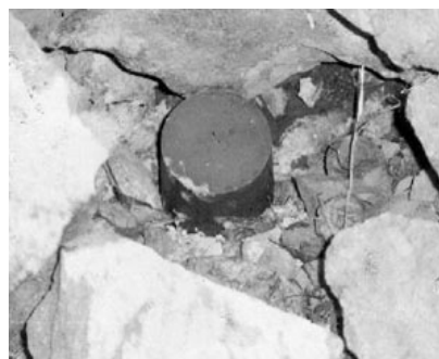
Obrázky 15, 16 – Radioizotopový termoelektrický generátor, zářič Sr-90.
