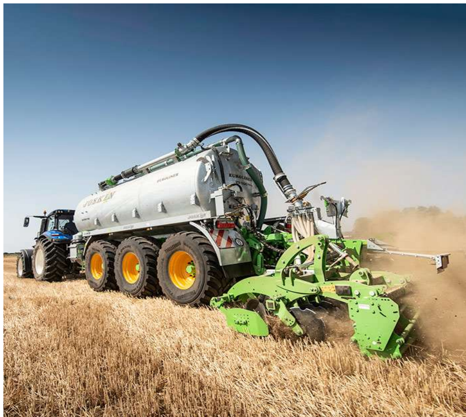
Obrázek 1.2: Aplikace kejdy se zapravením do strniště (joskin.com, 2024)
