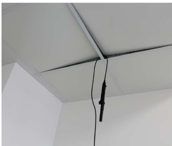
Sonda byla zavěšena 45 cm pod stropem
