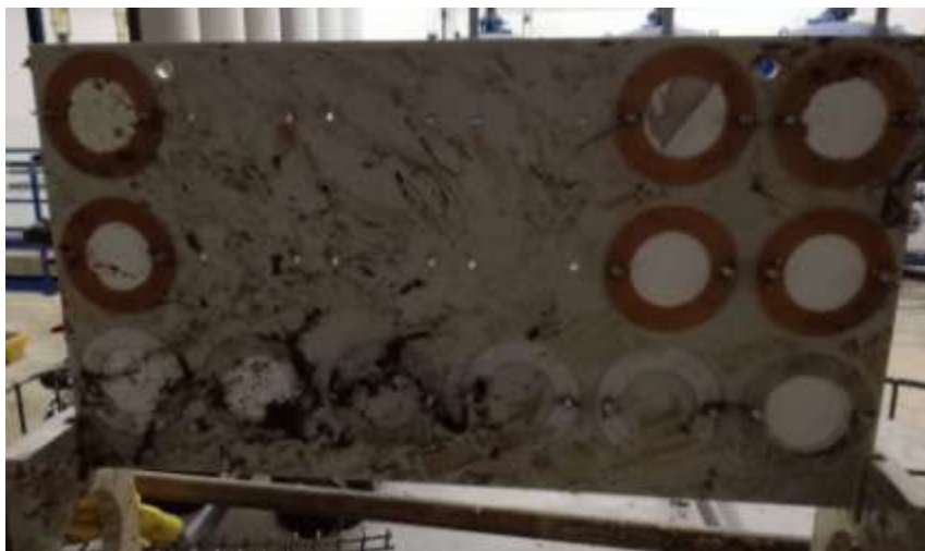
Obrázek 28: Modul s poškozenými membránami po první havárii
