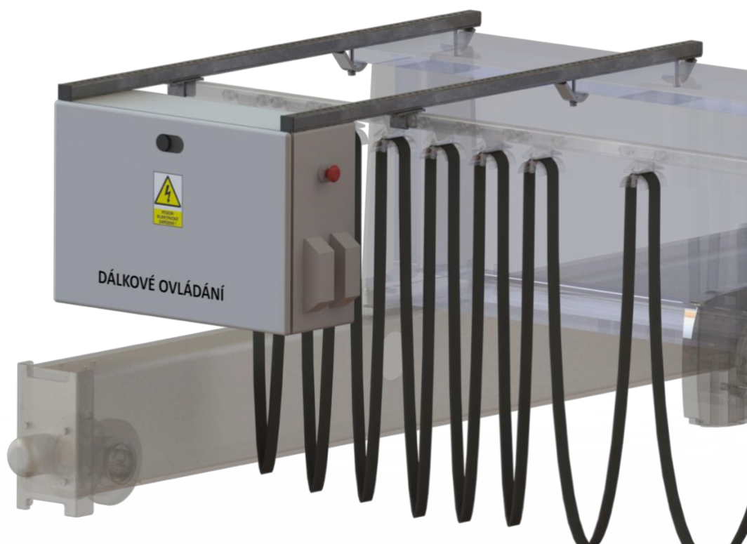
Obr. 54 Umístění rozvaděče na hlavním nosníku
