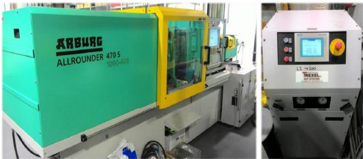
Obr. 3.3 Vstřikovací stroj Arburg ALLROUNDER 470 S 1000-400 s modulem pro technologii MuCell
