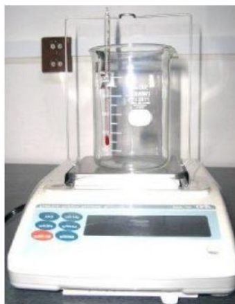
Obr. 3.5 Analytické hustotní váhy AND GF 300
