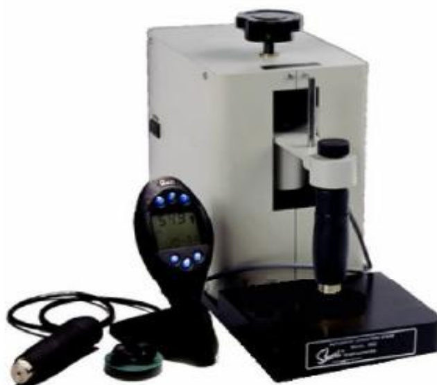
Obr 3.6 Tvrdoměr Shore D s vodícím stojánkem
