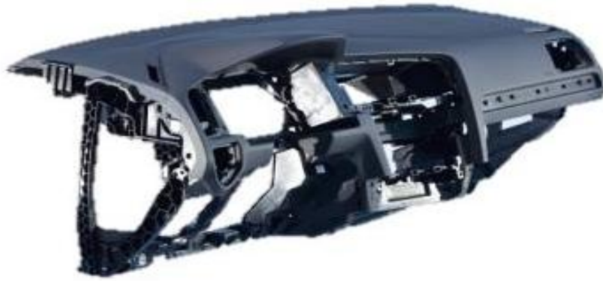
Obr. 2. 3 Příklad použití polymerního kompozitu se skleněnými vlákny v automobilovém průmyslu [8]
