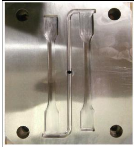
Obr. 3.4 Tvarová deska (tvárnice) vstříkací formy
