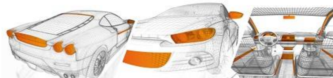
Obr. 2.6 Příklad použití polymerního kompozitu s přírodními vlákny (oranžově vyznačené části)
