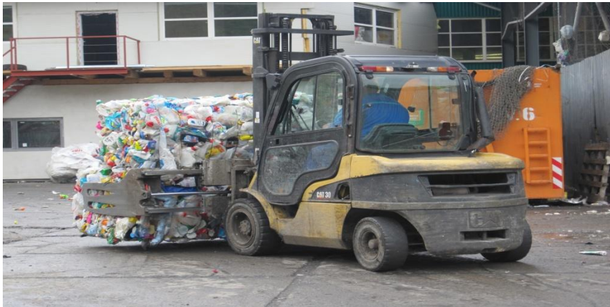
Obr. č. 11 – Manipulace s balíky po areálu, pomocí vysokozdvížného vozíku.
