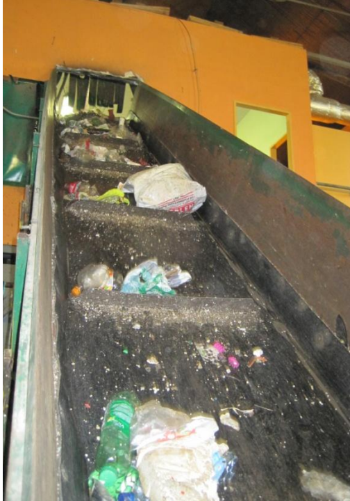
Obr. č. 5 – Pásový dopravník k dotřídovací lince.
