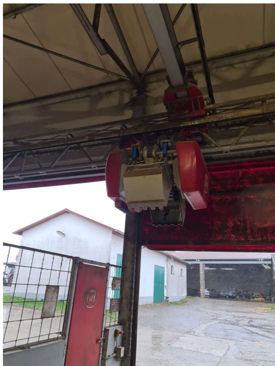
Obrázek č. 8. Nakládací portálový jeřáb krmného robota (Autor: Pavel Hron)
