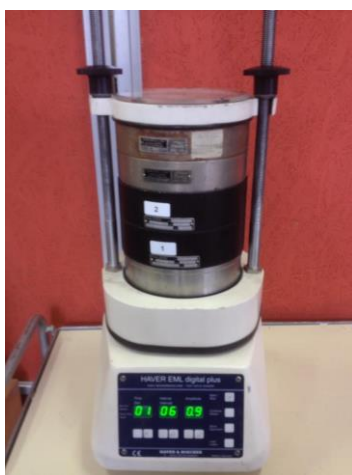
Obr. 6 Laboratorní síť Haver EML 200
