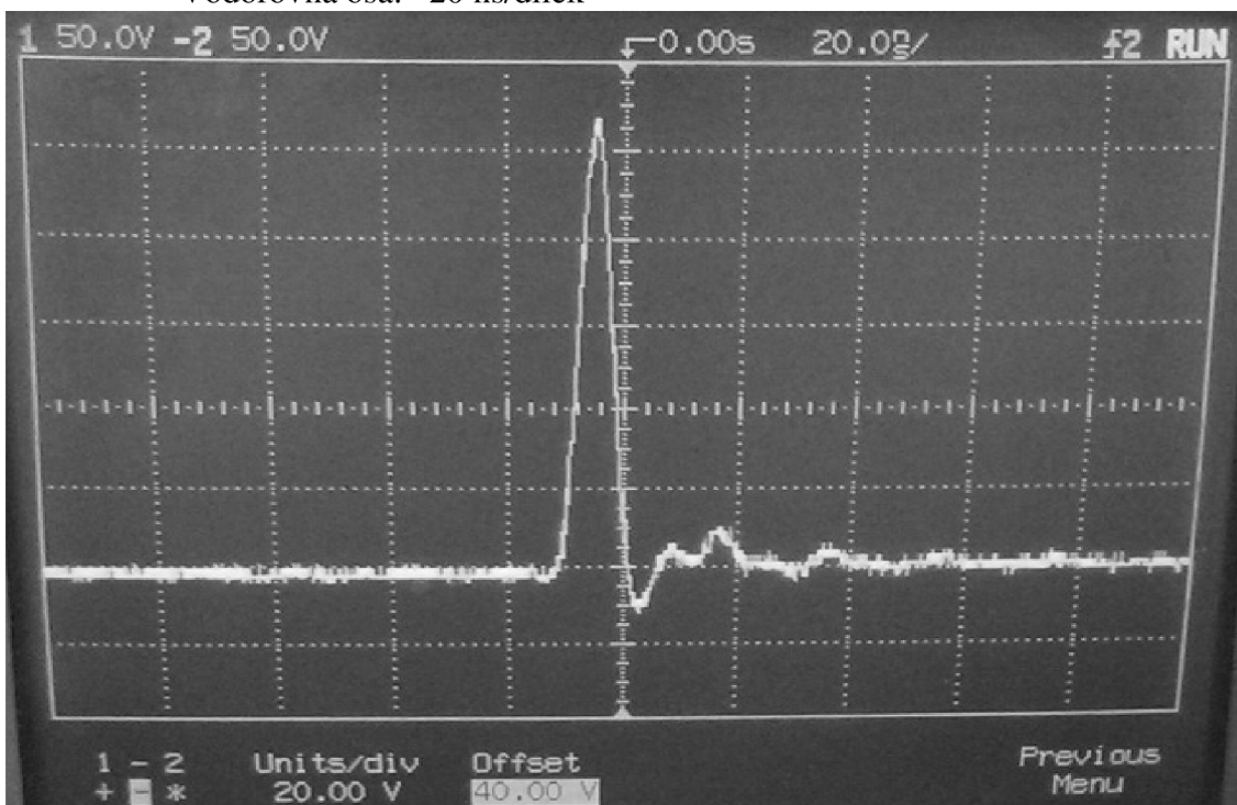
Obr.10. 3: Časový průběh pulsu generátoru
