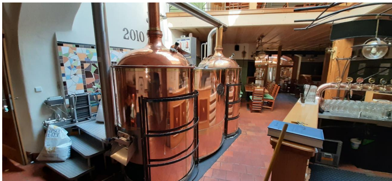
Obr. 8 Příklad varny s potrubím ze svezovací kádě do párníku mladinové pánve
