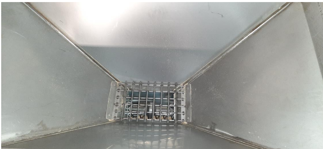
Obr. 2 Vnitřek násypky šrotovníku s ochrannou mřížkou a magnety pro zachycení kovových příměsí
