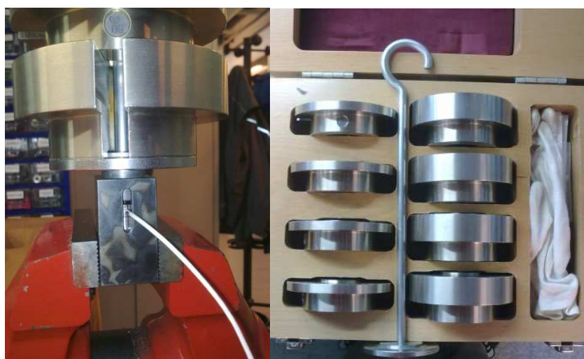
Obr. 32 Způsob uchycení snímače a použité závaží
