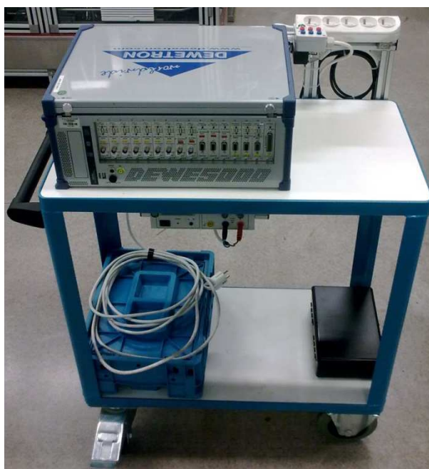
Obr. 61 Vícekanálový měřicí přístroj Dewetron
