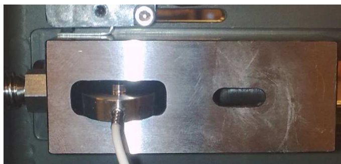
Obr. 59 Montáž silového snímače
