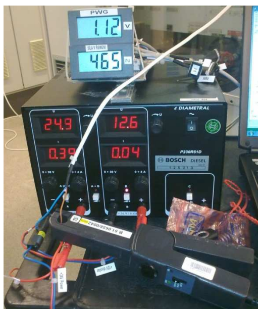
Obr. 64 Měření proudu lineárního pohonu
