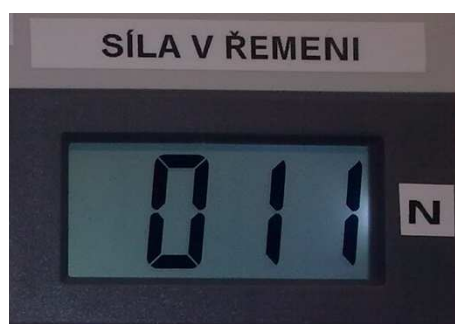
Obr. 63 Digitální panelový voltmetr
