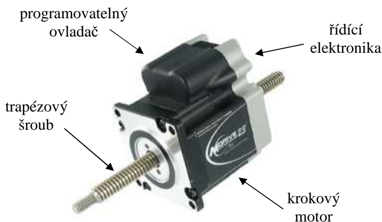
Obr. 21 Lineární pohon MDrive 23 [6]
