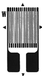
Obr. 26 Meandrující struktura tenzometru
