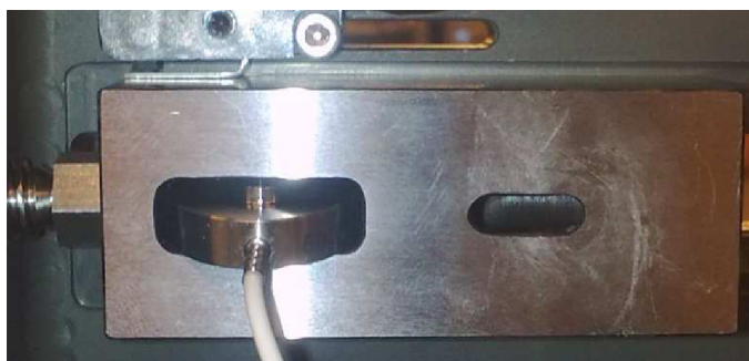
Obr. 59 Montáž silového snímače
