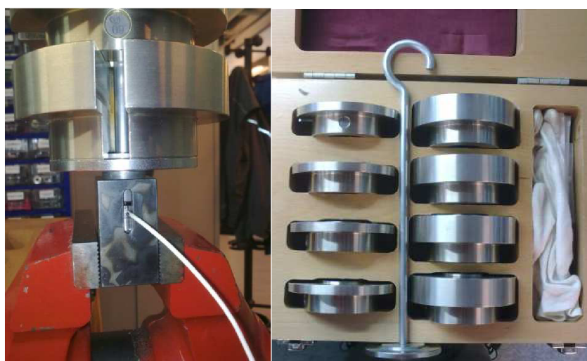
Obr. 32 Způsob uchycení snímače a použité závaží
