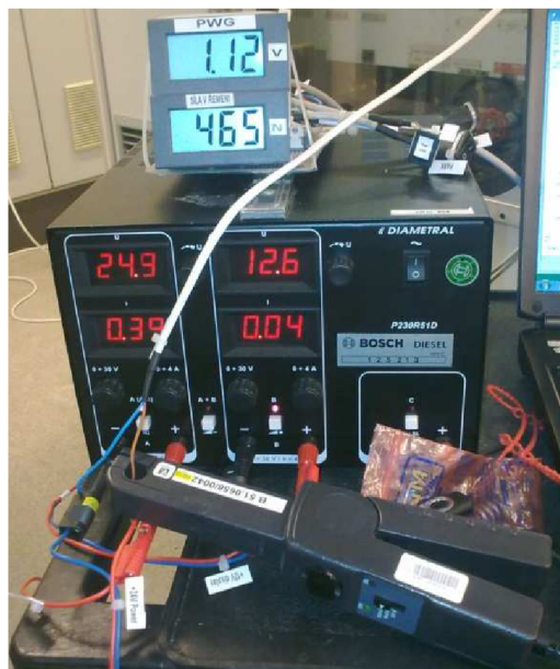
Obr. 64 Měření proudu lineárního pohonu
