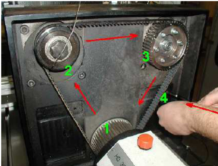
Obr. 17 Měřící bod na řemeni [1]
