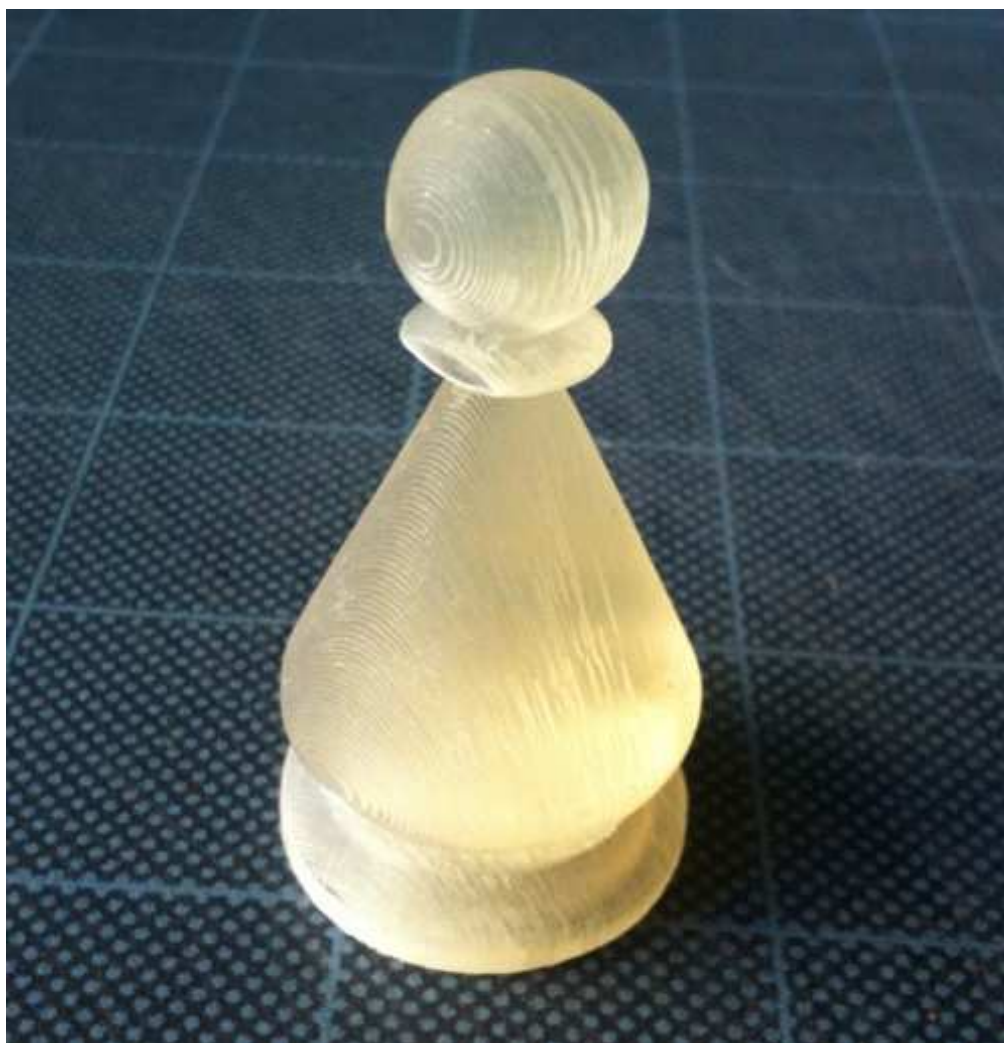
Obr. 1.10 Model, vytvořený metodou LOM, s charakteristickou strukturou [14]
