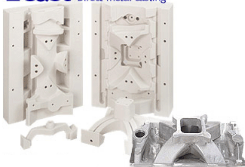
Obr. 2.7 ukázka postupu výroby odlitku metodou ZCast a výsledná součást [26]
