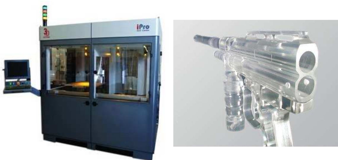
Obr. 1.3 stereolitografické centrum iPro 9000 XL s ukázkou konkrétního výrobku [6] [7]
