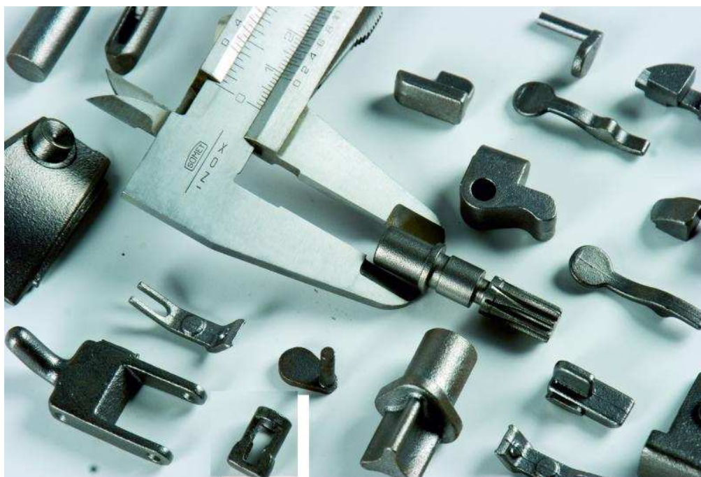
Obr.1 Příklady možností kombinace RP a přesného lití [1]
