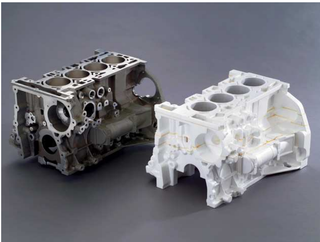
Obr. 2.5 Ukázka modelu a z něj vytvořeného odlitku [23]
