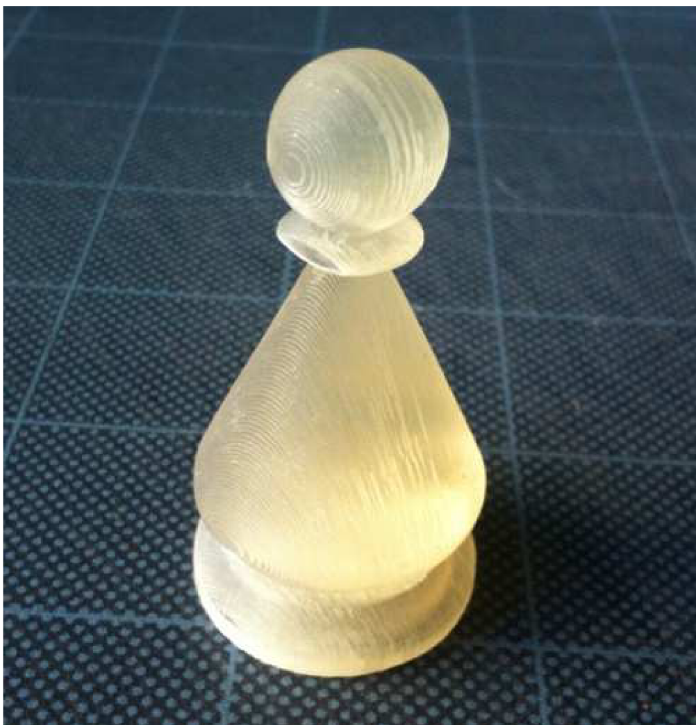
Obr. 1.10 Model, vytvořený metodou LOM, s charakteristickou strukturou [14]
