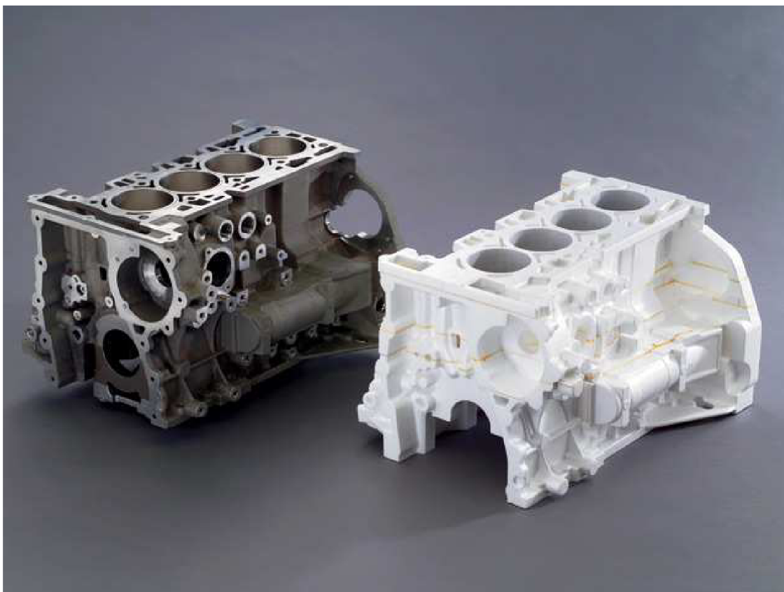
Obr. 2.5 Ukázka modelu a z něj vytvořeného odlitku [23]
