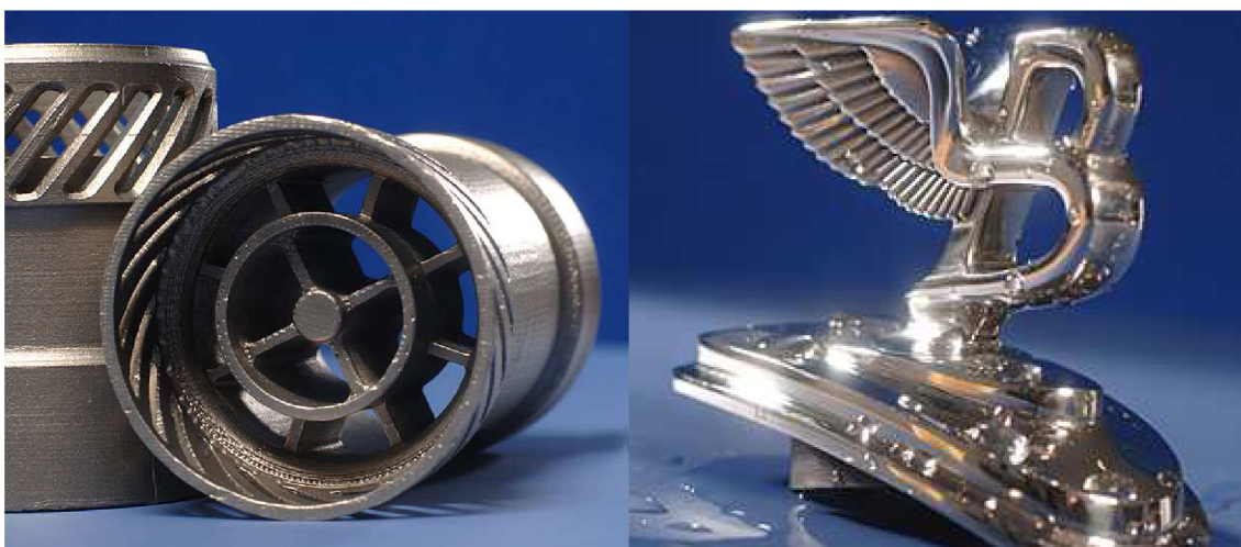
Obr. 2.1 Příklad hrubého (vlevo) a opracovaného odlitku, získaného Lost-Wax technologií [18]
