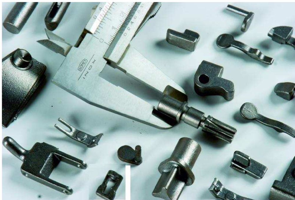
Obr.1 Příklady možností kombinace RP a přesného lití [1]
