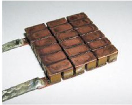
Obr. 7 Konstrukce termoelektrického článku bez keramických desek [20]
