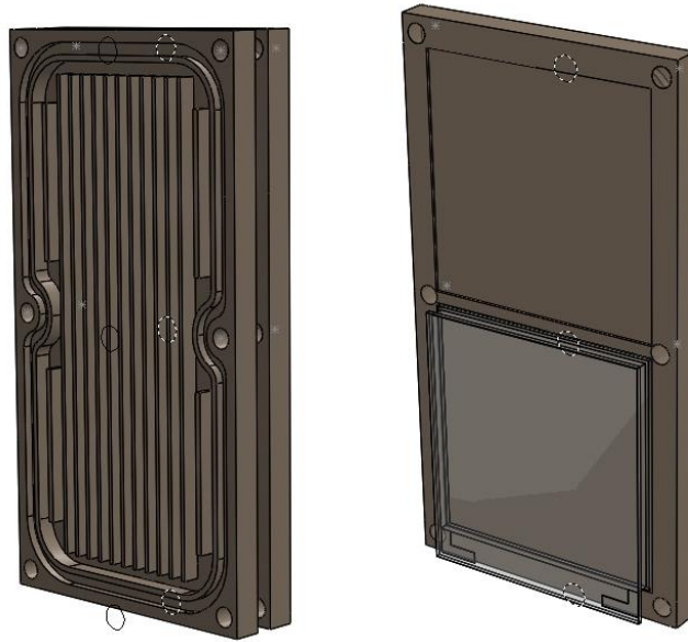
Obr. 36 Měděné teplosměnné elementy výměníku
