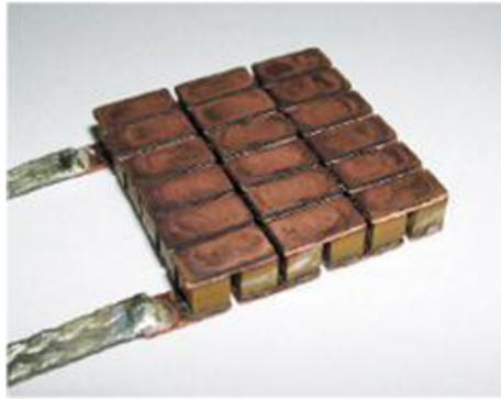
Obr. 7 Konstrukce termoelektrického článku bez keramických desek [20]
