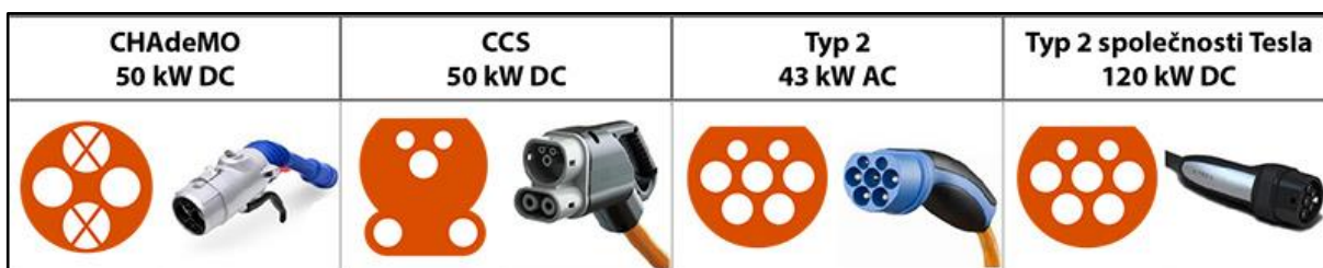
Obrázok 6 Typy konektorov pre rýchle/ultrarýchle nabíjanie [15]
