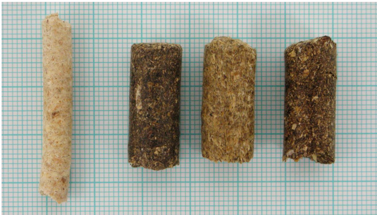
Obrázek 27. Pelety pro spalování v kotli VERNER A251, zleva: dřevo, řepka, pšenice, mix
