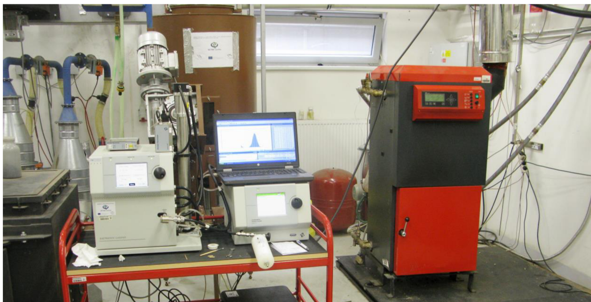
Obrázek 26. Propojení přístroje TSI (vlevo) a kotle VERNER A251 (vpravo)
