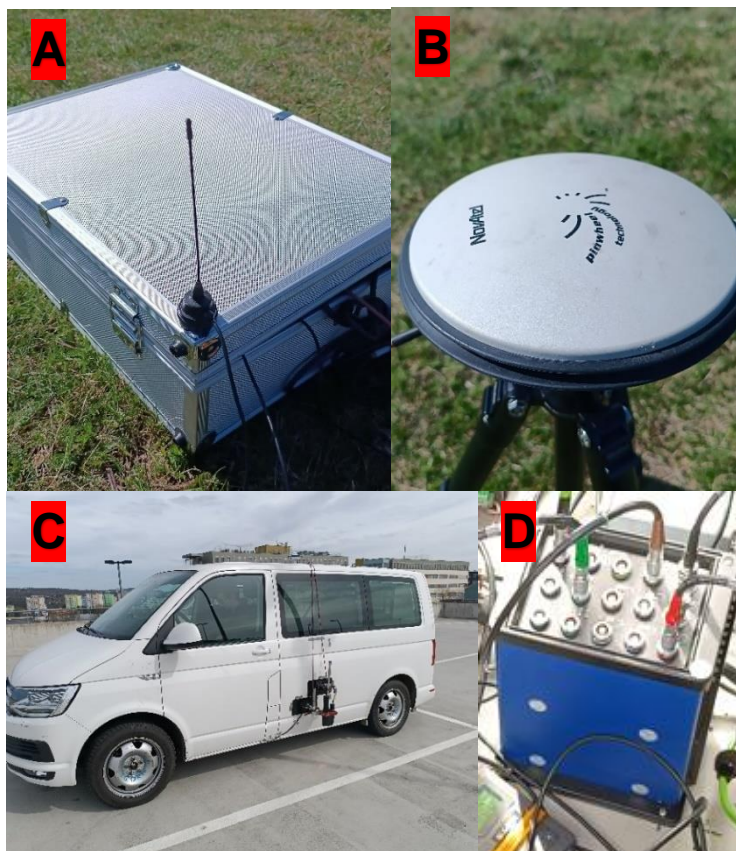
Obr. 35 A) Anténa, B) Satelit, C) Experimentální vozidlo, D) ADMA ve vozidle
