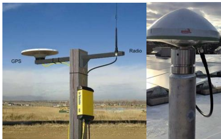
Obr. 26 Vlevo básová stanice (GPS přijímač) a vpravo virtuální básová stanice [80]
