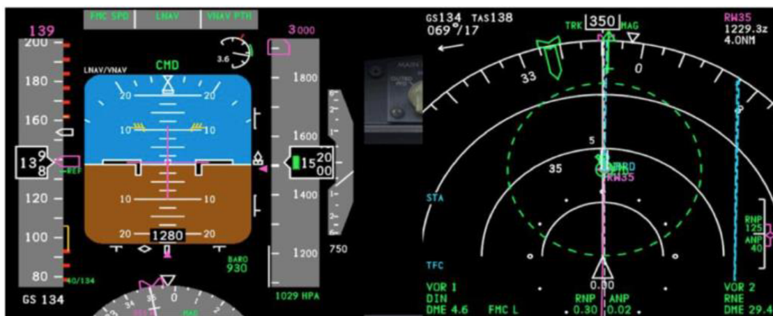
Obr. 17 Vlevo hlavní letový displej a vpravo navigační obrazovka [48]
