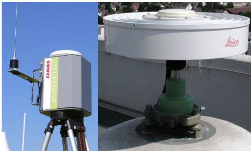
Obr. 25 Vlevo pevná referenční stanice a vpravo přenosná referenční stanice DGPS [61]
