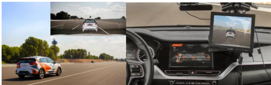
Obr. 29 Vehicle in the Loop (VIL) testování na uzavřeném okruhu [87]
