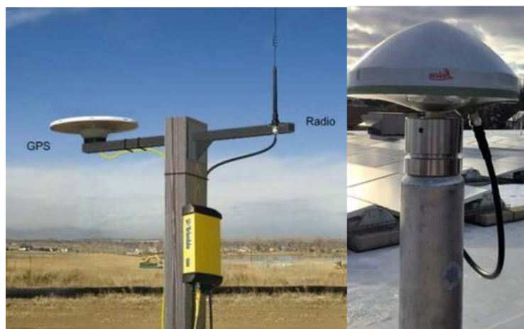
Obr. 26 Vlevo bázevá stanice (GPS přijímač) a vpravo virtuální bázevá stanice [80]
