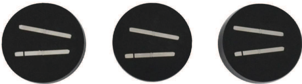
Obr. 6.16 Připravené vzorky pro metalografické a tvrdostní šetření.
