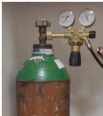
Obr. 6.2 V experimentu použitá tlaková láhev s argonem.
