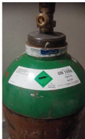
Obr. 6.2 V experimentu použitá tlaková láhev s argonem.
