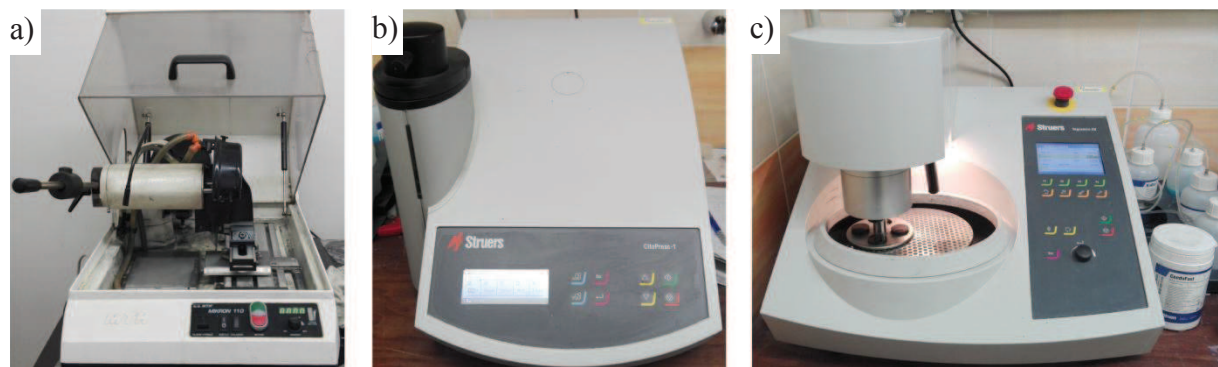
a) metalografická pila MTH MIKRON 110, b) lis Streuers CitoPress-1, c) metalografická leštička Struers Tegramin-20
