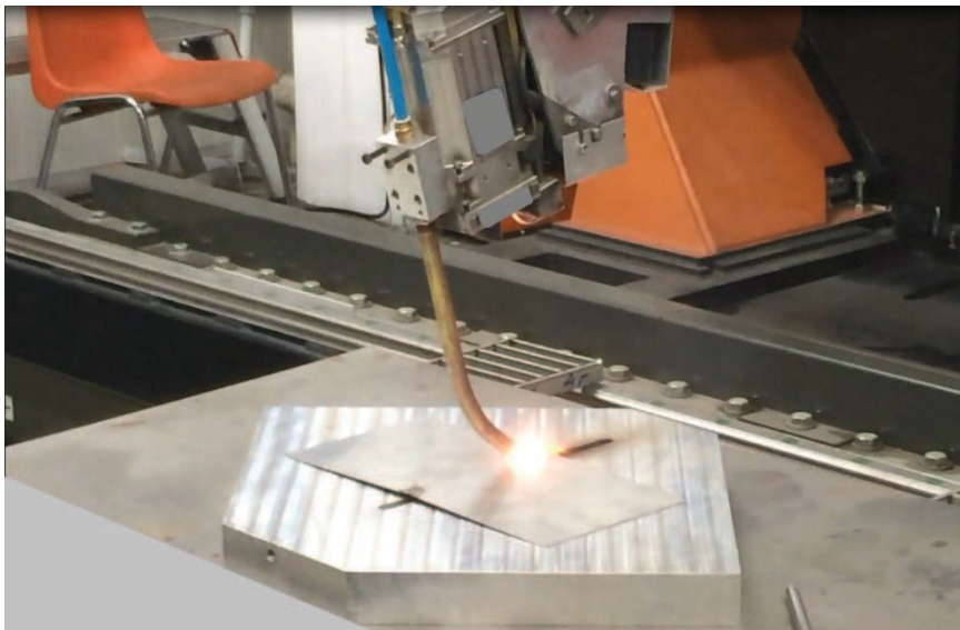
Obr. 6.28 Svařování dílců plechu v rámci experimentu II.
