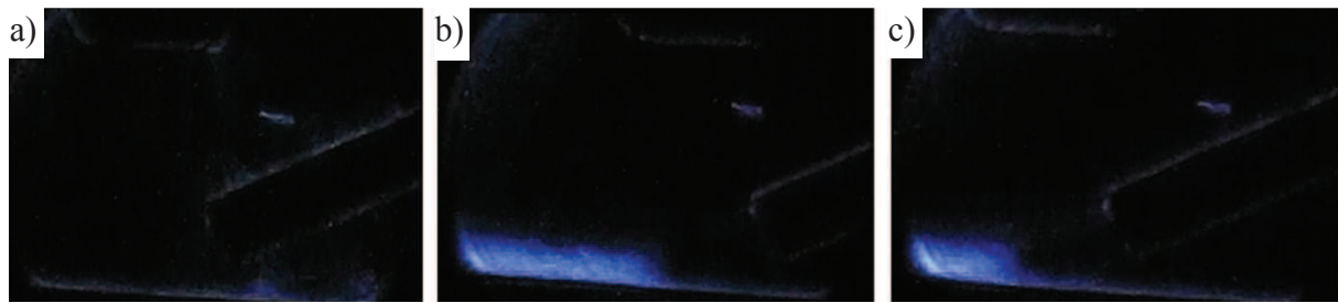
Přívod tryskou: a) koaxiální, b) boční, ve směru pohybu, c) boční, proti směru pohybu. Obr. 6.9 Proudění argonu.
