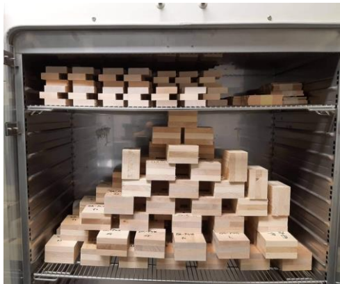
Obrázek 18. Rozestavení těles v klimatizační komoře
