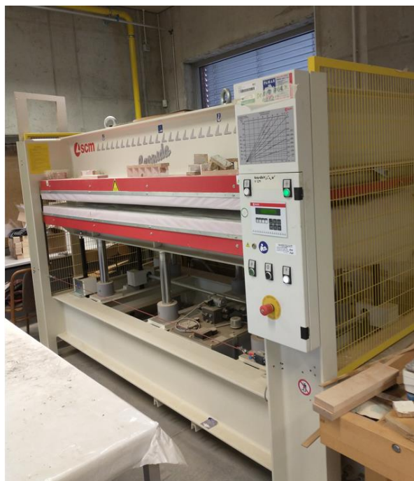
Obrázek 16. Hydraulický lis SCM Sergiani Leopeda gs 6/90
