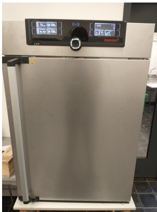
Obrázek 23. Klimatizační komora Memmert 30–1060
