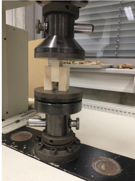
Obrázek 20. Princip testování smykové pevnosti
