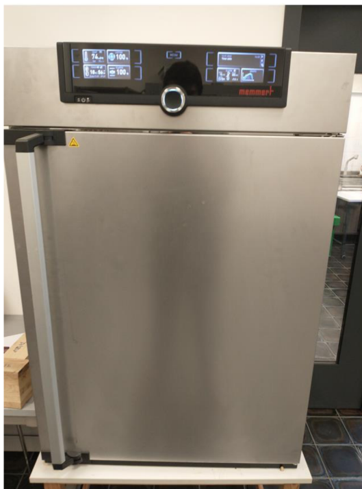
Obrázek 23. Klimatizační komora Memmert 30–1060
