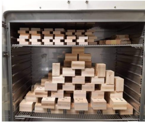
Obrázek 18. Rozestavení těles v klimatizační komoře
