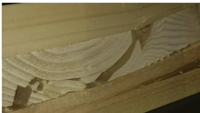
Obrázek 8. Typické porušení pro valivý smyk (Sikora et al., 2016)
