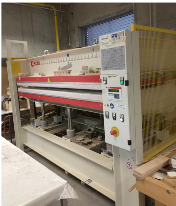
Obrázek 16. Hydraulický lis SCM Sergiani Leopeda gs 6/90
