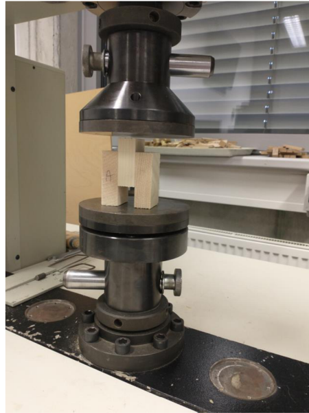
Obrázek 20. Princip testování smykové pevnosti
