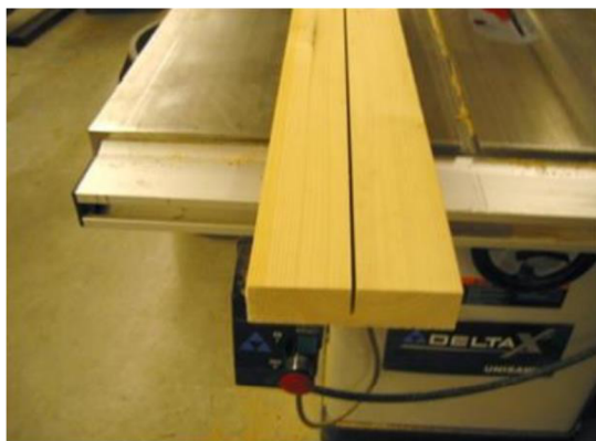
Obrázek 4. Systém odlehčení smršťování dřeva (Karacabeyli a Gagnon, 2019)
