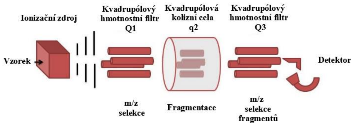
Obr. 6 Schéma trojitého kvadrupólu (upraveno podle www.en.wikipedia.org , 19. 4. 2018).
