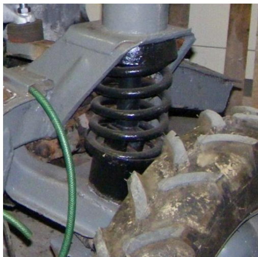
Obrázek 13 Podložená pružina přední nápravy.
