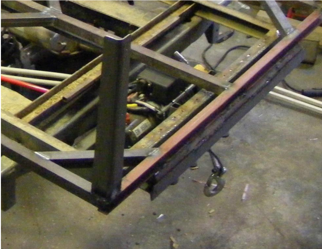
Obrázek 14 Přivařený pant korby.
