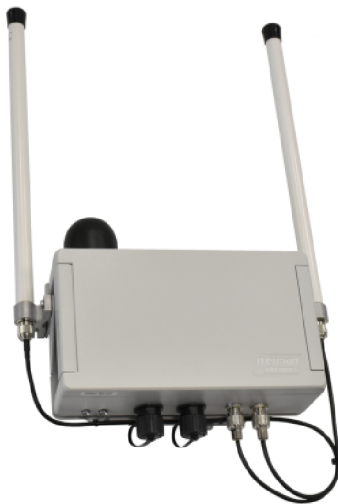
Obr. 2.3: Samostatná jednotka RSU[10]
