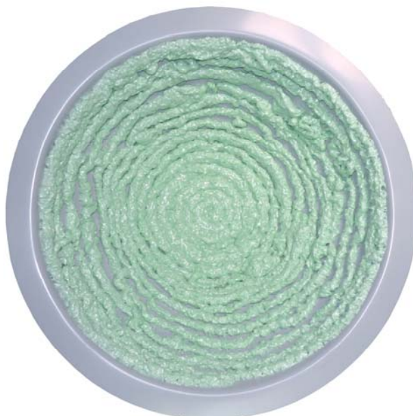
Obr. 28 – Vyplnění vnitřku polokoule montážní pěnou
