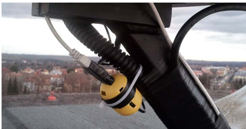
Obr. 51 – Umístění USB teploměru na železném rameni
