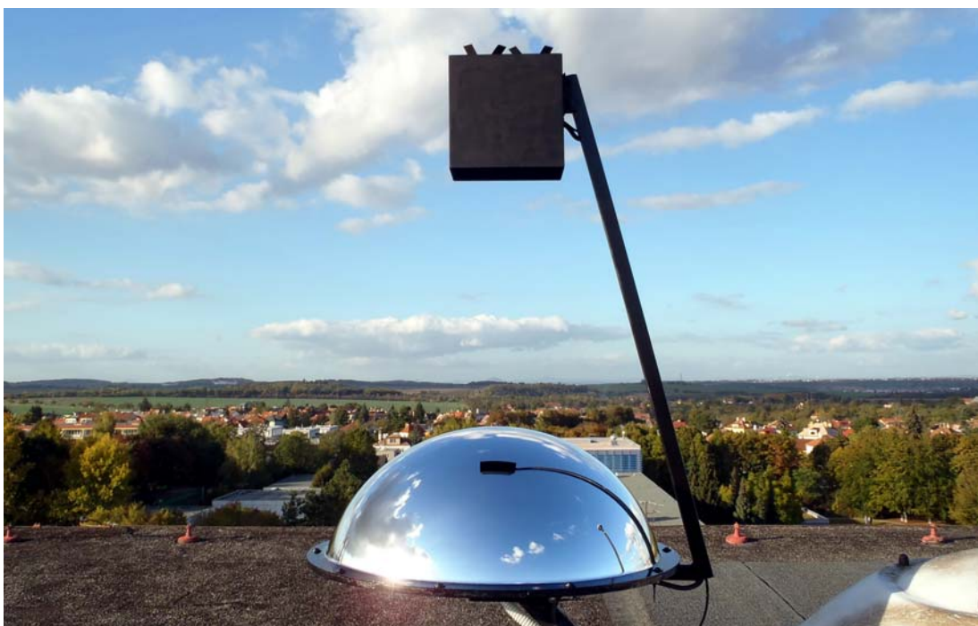
Obr. 54 – Nová konstrukce vyhřívané optiky
