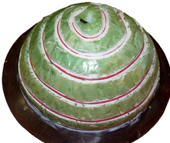
Obr. 43 – Polokoule z montážní pěny s topným kabelem
